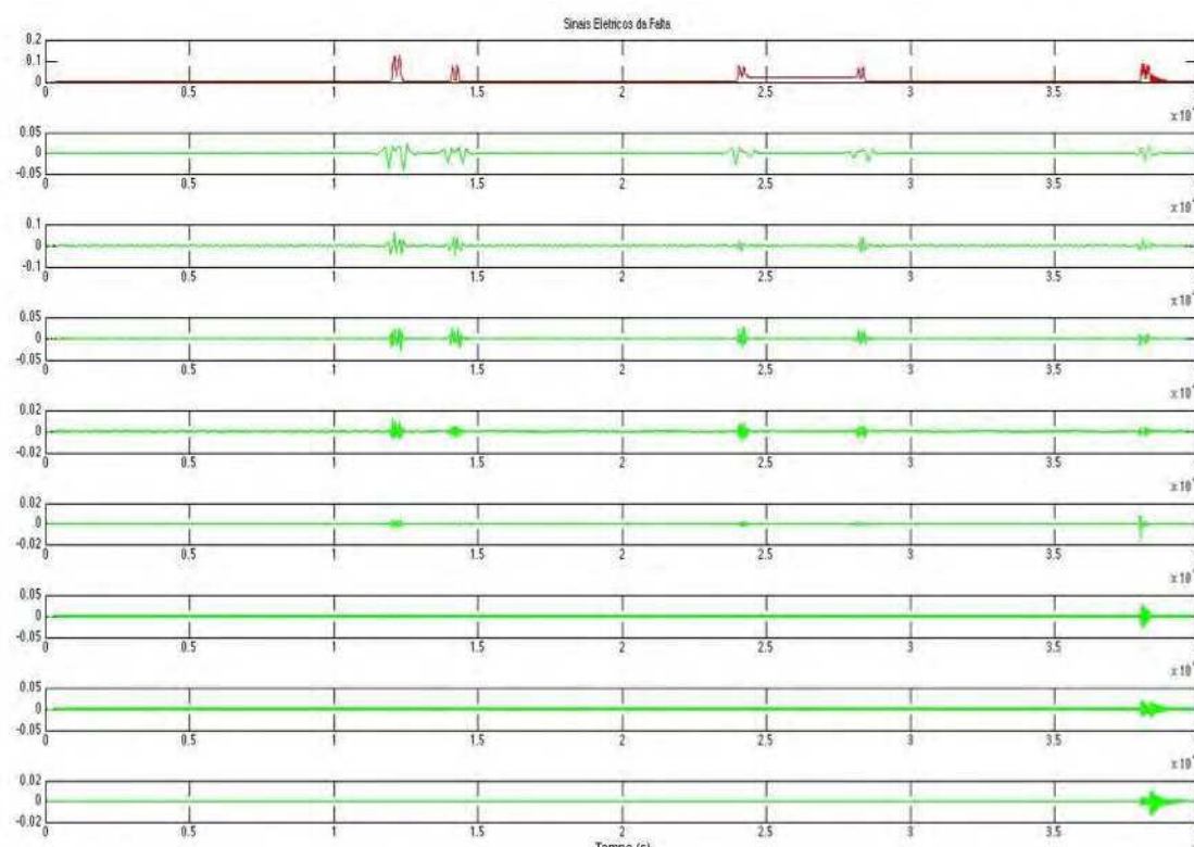
Figura 6.2: Combinação da técnica de observação de Harmônicos de baixa ordem de Sequência negativa com a Transformada de Wavelet para o caso 1
