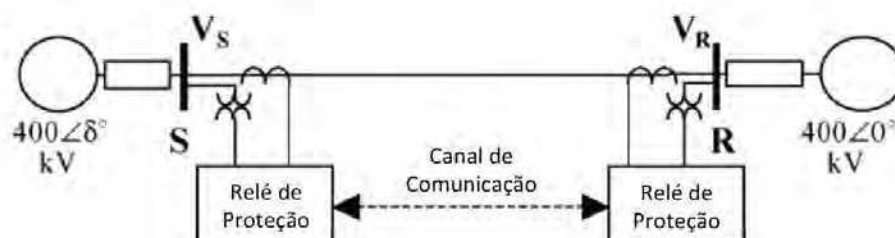
Figura 2.11: Sistema baseado no conceito de potência diferencial. Fonte: Adaptado de (DARWISH et al., 2005)
