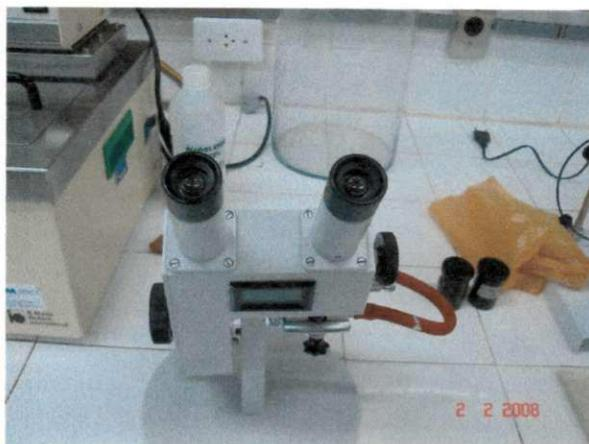
Figura 3.3 – Refratômetro (utilizado para a determinação dos sólidos solúveis totais (°Brix).
