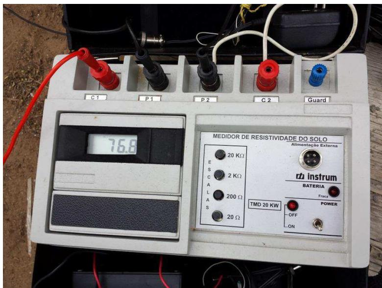
**Figura 4. Fotografia do terrômetro em funcionamento com valor de resistência de aterramento fora dos valores normatizados pela NDU 001.**
