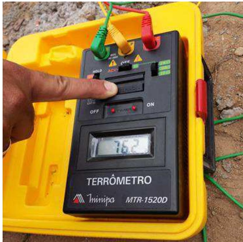
**Figura 6. Fotografia do terrômetro em funcionamento também com valor de resistência de aterramento fora dos valores normatizados pela NDU 001.**
