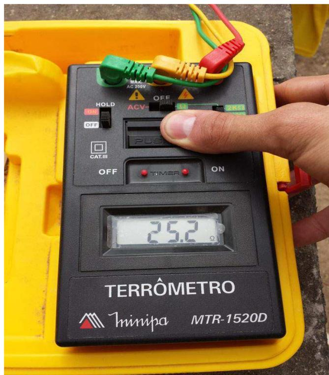
Figura 7. Fotografia do terrômetro em funcionamento ainda fora, mas próximo do valor de resistência de aterramento normalizados pela NDU 001.
