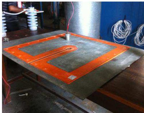
Qualquer sinal visível de deterioração tais como rachaduras ou perfurações, deve ser considerado como evidência de falha acarretando na reprovação do lençol isolante. Foram ensaiados cinco lençóis de borracha conforme mostrado na Tabela 8, onde a reprovação do item 05.04 ocorreu devido à uma perfuração no equipamento de proteção, ocasionada após a aplicação da tensão de ensaio.
