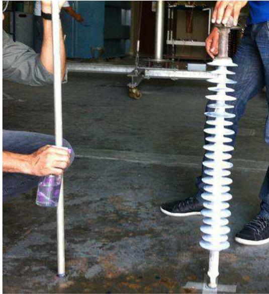
Para realização do ensaio utilizou-se Gerador de Tensão CA, 120 kV – 1,0 A e o Divisor de Tensão Capacitivo 7816/1. Na Figura 4 é apresentado, o diagrama esquemático da montagem e uma fotografia da montagem do isolador no laboratório, respectivamente.
