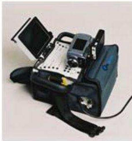
As medições de ruído ultrassônico foram realizadas a uma distância de aproximadamente 6,5 metros dos isoladores. O processo de atenuação dos níveis de ruídos ultrassônicos depende da distância entre fonte e objeto. Isso implica que, a partir de determinada distância, a eficiência na detecção de ruídos (dos atuais equipamentos), cai para limites que podem ser associados aos ruídos brancos do ambiente. Utilizou-se para as medições o equipamento SDT200™, mostrado na Figura 6.
