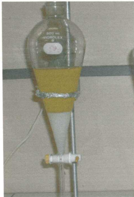
Figura 3.2 Processo de lavagem do biodiesel – rota homogênea
