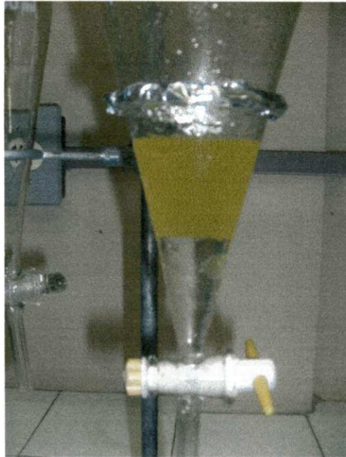
Figura 3.7 Processo de lavagem do biodiesel – rota heterogênea Fonte: Arquivo pessoal
