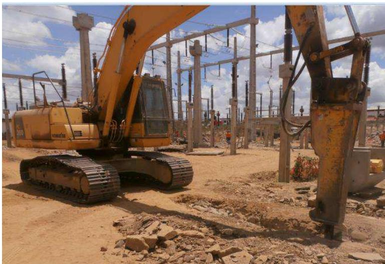
Figura 94. Fotografia da escavadeira hidráulica com martelo.
