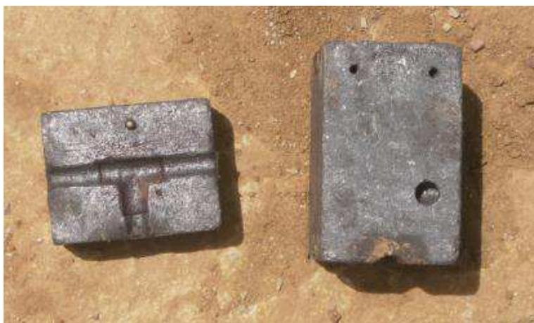
Figura 107. Fotografia do molde utilizado para as soldas tipo T.
