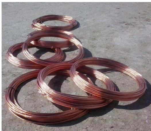
Figura 88. Fotografia de escoltas do cabo de cobre nu 95 mm<sup>2</sup>.
