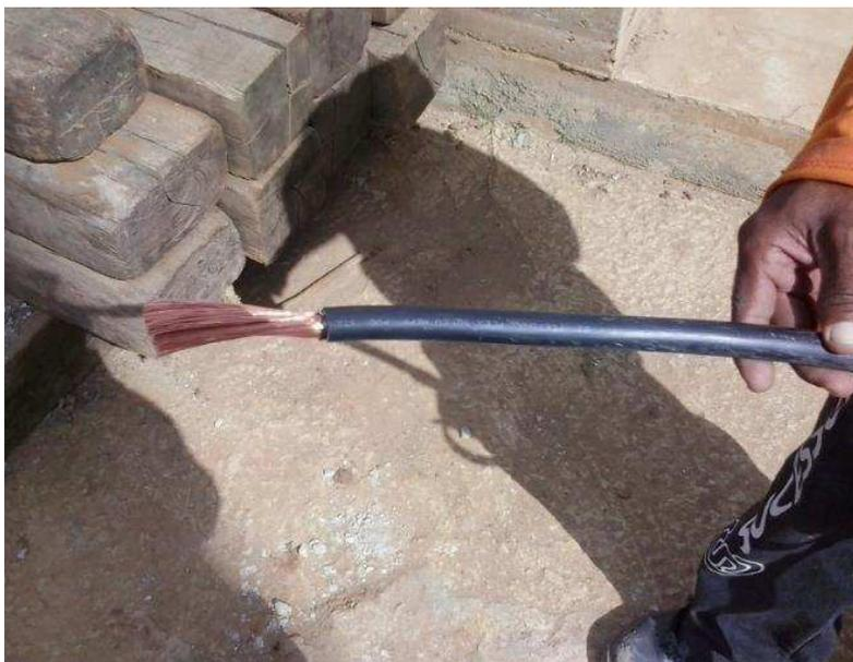
Figura 90. Fotografia Cabo de cobre isolado 95 mm<sup>2</sup>
