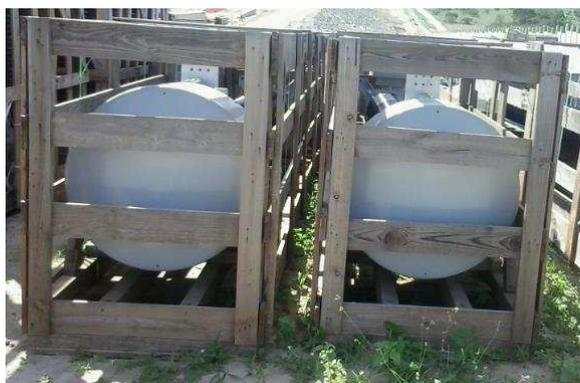
Figura 10. Fotografia da vista superior de um TC de 500 kV embalado em caixa de madeira.
