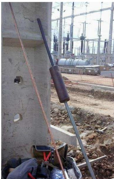
Figura 108. Fotografia do batedor e da haste para aterramento.
