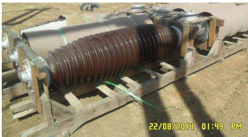
Figura 41. Fotografia do disjuntor de 500 kV desembalado.
