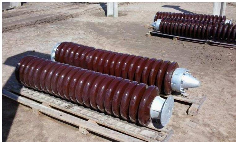
Figura 33. Fotografia de um IP de 500 kV desembalado e desmontado.
