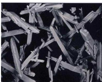
**Figura 22:** Cristais de sulfato tetrabásico ( $4PbO + PbSO_4$ )
