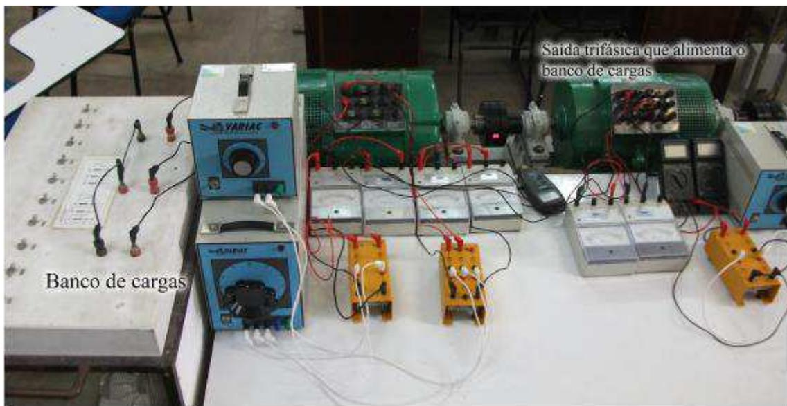
Figura 29 - Imagem ampla do ensaio de característica externa da máquina síncrona.
