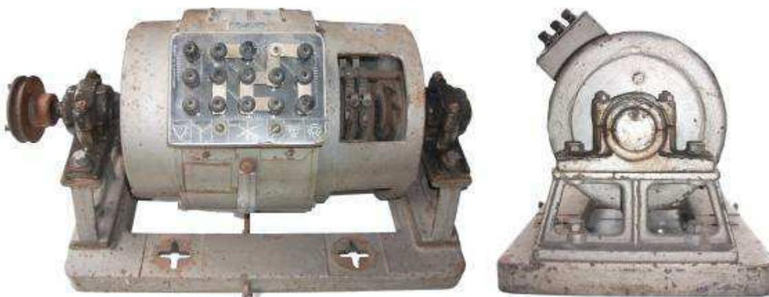
Figura 3 - Visão frontal e lateral da máquina assíncrona.
