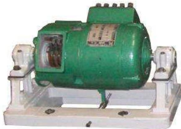
Figura 9 - Máquina Assíncrona pós-recondicionamento.
