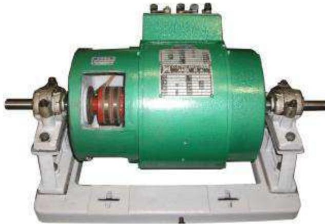
Figura 8 - Máquina Síncrona pós recondicionamento.
