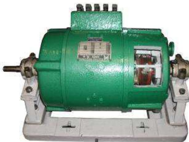
Figura 7 - Máquina CC pós-recondicionamento.
