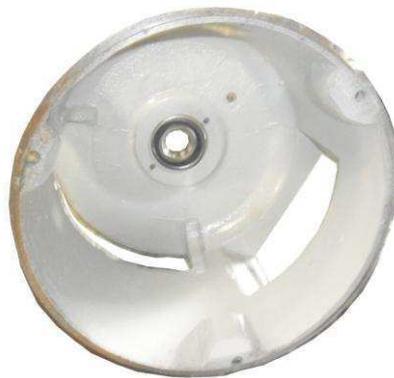
Figura 4 - Carcaças pintadas com tinta envernizadora branca.
