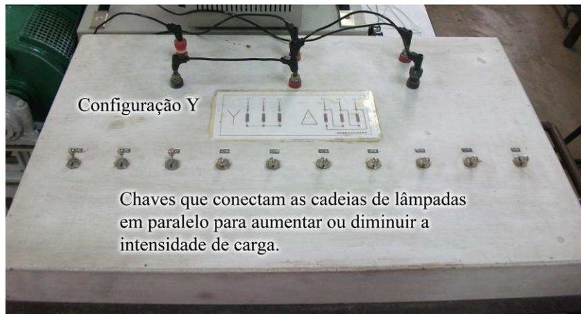
Figura 30 - Painel de controle de conexão das cargas.
