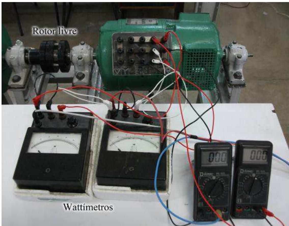
Figura 44 - Imagem do ensaio de rotor livre da máquina assíncrona.
