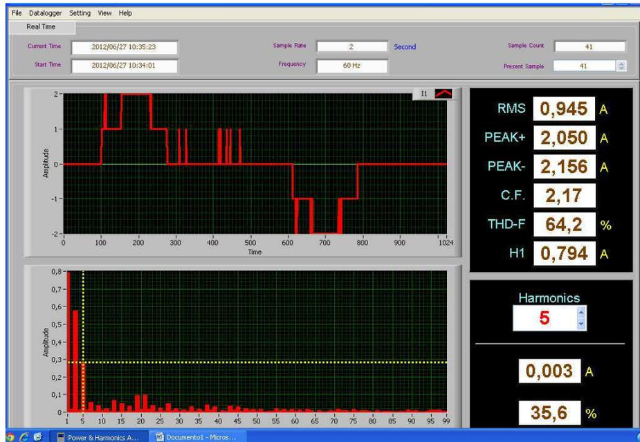
Figura 2.16: Tela de harmônicas exibida pelo *software* do analisador, exibindo a quinta harmônica.
