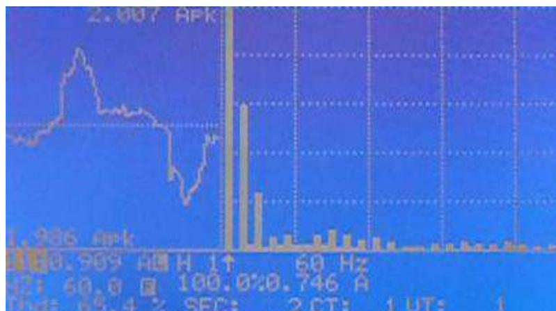
Figura 2.8: Tela do analisador com a forma de onda de corrente do circuito e o gráfico de amplitude de suas harmônicas.
