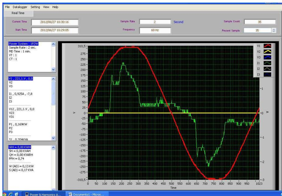
Figura 2.13: Tela das formas de onda exibida pelo *software* do analisador.
