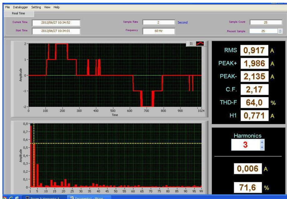
Figura 2.15: Tela de harmônicas exibida pelo *software* do analisador, exibindo a terceira harmônica.
