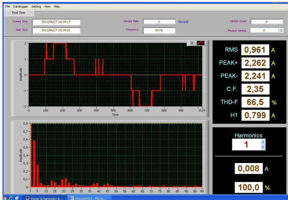
Figura 2.14: Tela de harmônicas exibida pelo *software* do analisador, exibindo o valor fundamental.
