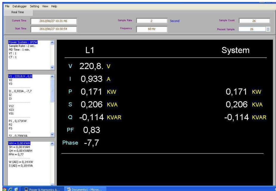
Figura 2.11: Tela de potência exibida pelo *software* do analisador.
