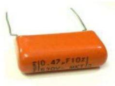
Figura 1.7 – Capacitor de poliéster
