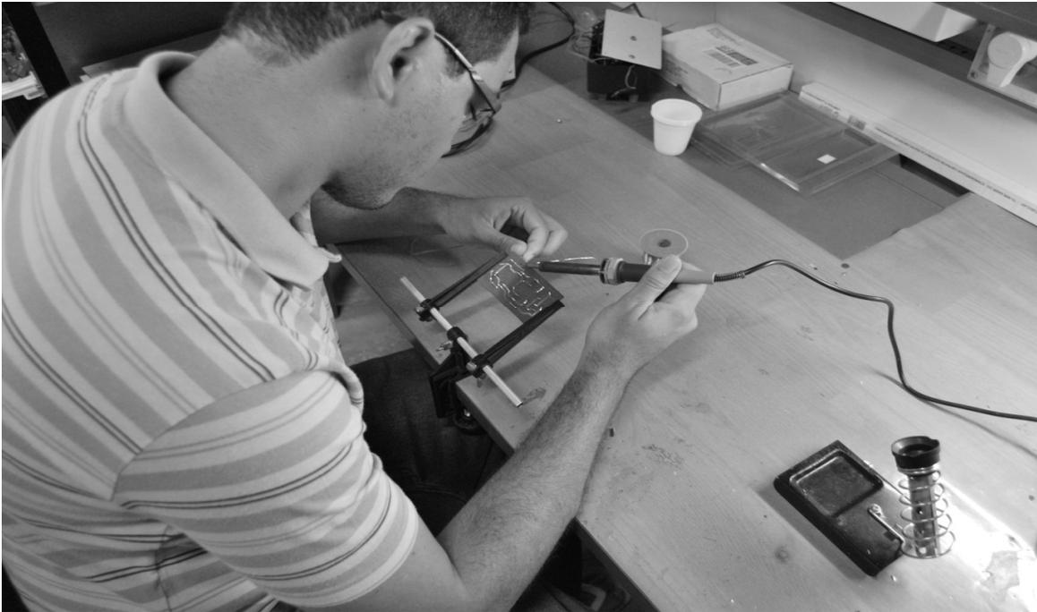
Figura 2.12 – Soldagem de componentes a placa
