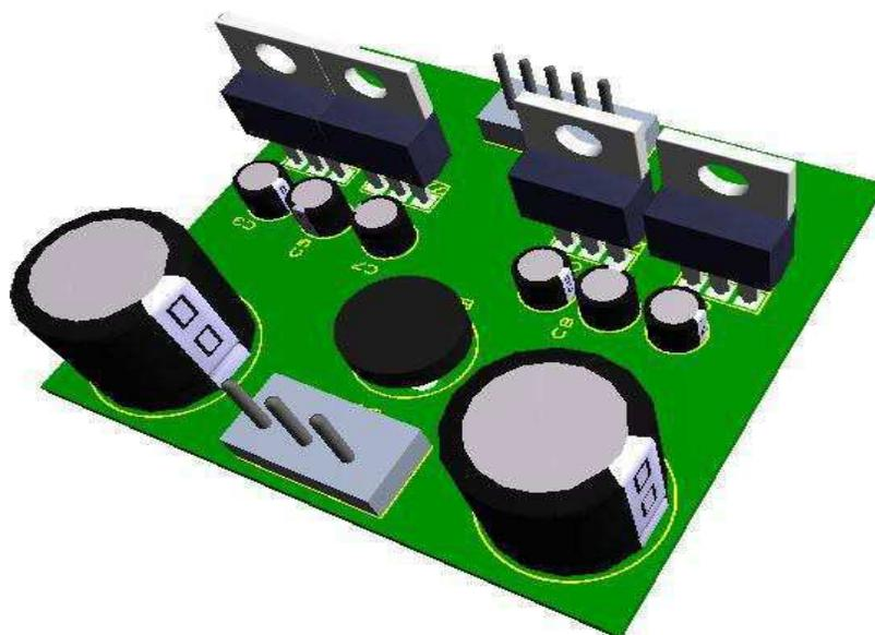
Figura 2.9 – Vista 3D do projeto da fonte simétrica de  $\pm 5\text{ V}$  e  $\pm 15\text{ V}$
