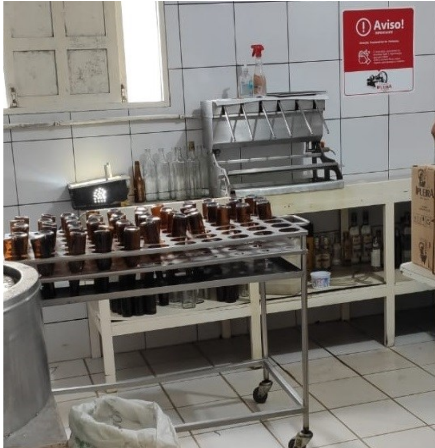
Fotografia 5 - Equipamentos para envase.
