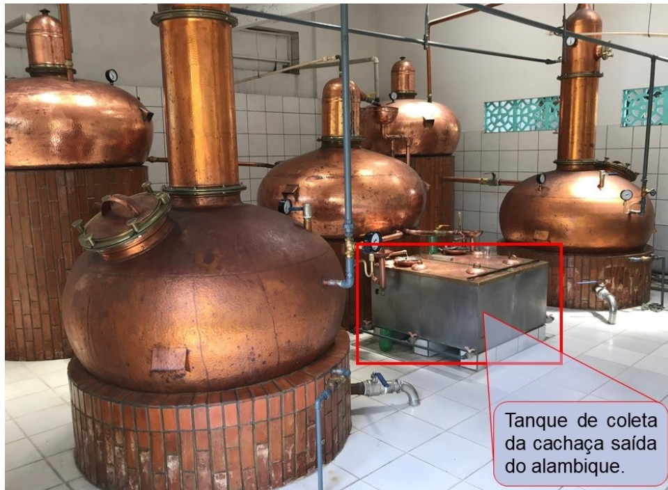
Fotografia 3 - Área de destilação, com destaque em vermelho, para o tanque que recebe o material recém destilado.
