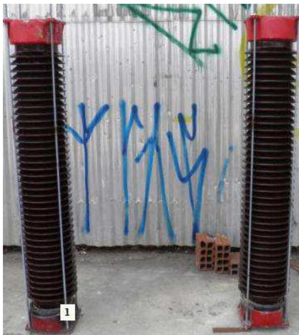
Figura 4.5 Pára-raios de número 1 e 7 com hastes metálicas (1) nas laterais.
