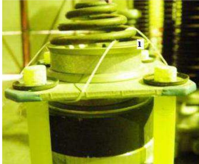
Figura 4.3 Mola (1) da parte superior da coluna de varistores.
