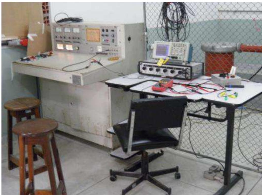
Figura 4.24. Mesa de controle, resistor shunt e osciloscópio.
