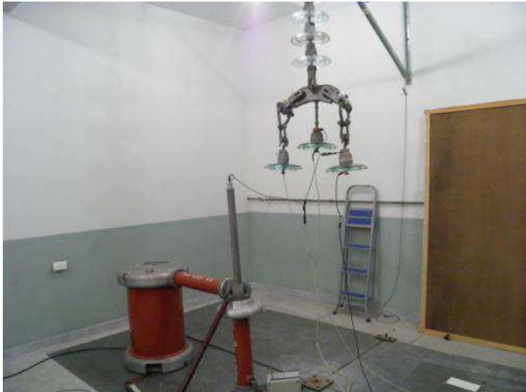
Figura 4.23. Transformador ,capacitores, resistor e isoladores.
