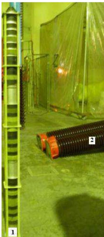
Figura 4.1 Coluna de varistores do Pára-Raios de óxido de zinco (1) e corpo de porcelana (2).
