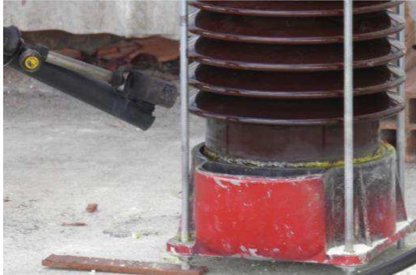
Figura 4.7 Derretimento do enxofre com auxílio do maçarico.
