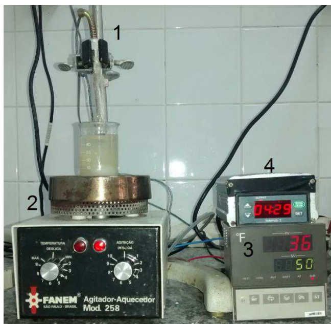
Figura 19 - Sistema de agitação/aquecimento adaptado para preparar a solução de quitosana com (1) sensor Pt 100, (2) agitador-aquecedor, (3) microcontrolador PID, (4) temporizador.
