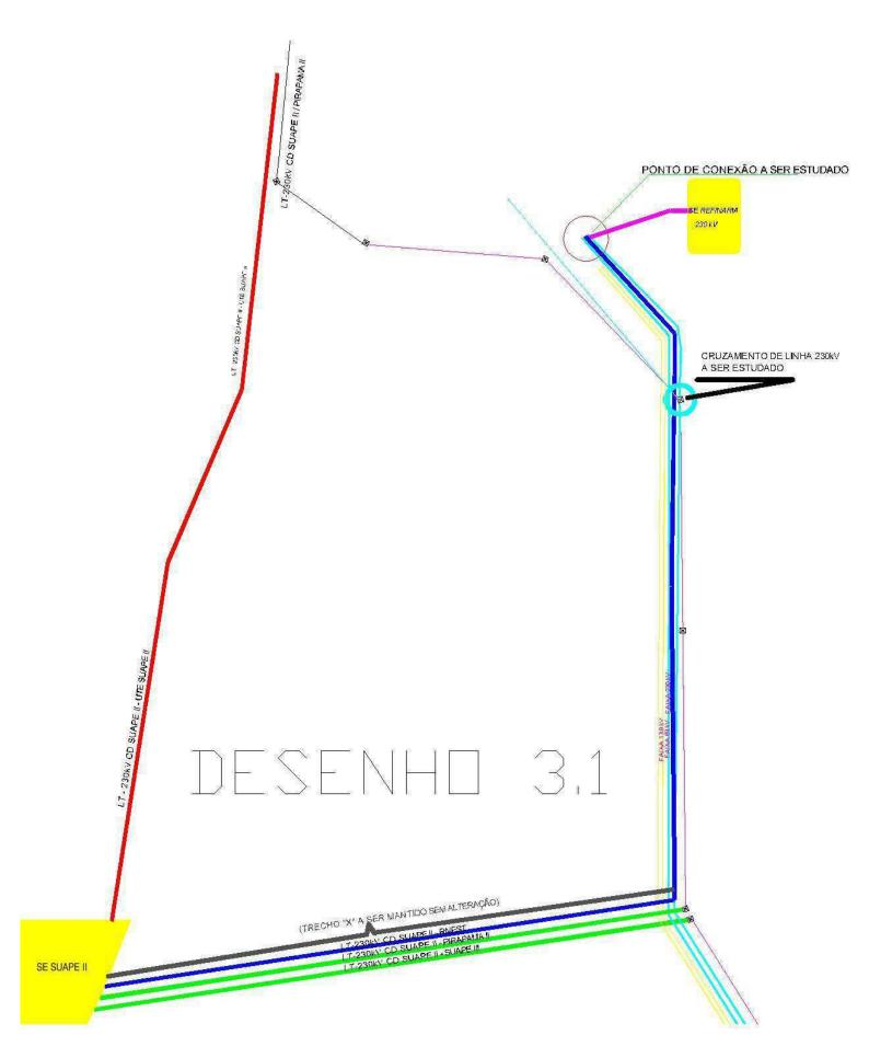
Figura 14 – Desenho 3.1 - Estudo Básico Locação LT 230 kV – RNEST x Suape II.
