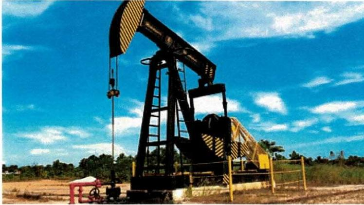
Figura 3 – Cavalo-de-pau, motor de tensão nominal 480 V
