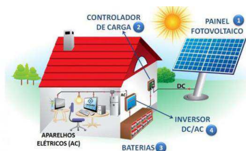
Figura 21: Sistema isolado com armazenamento.
