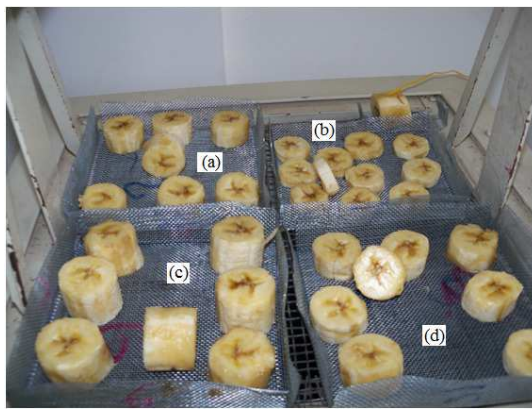
Figura 3.26 – Cestos na bandeja do secador com as bananas, com os quatro comprimentos estudados, cortados com as bitolas de: (a) 20,00 mm; (b) 10,00 mm; (c) 25,00 mm (d) 15,00 mm.
