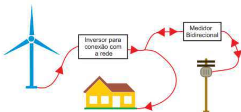
Figura 7: Configurações de um sistema conectado a rede de energia elétrica.
