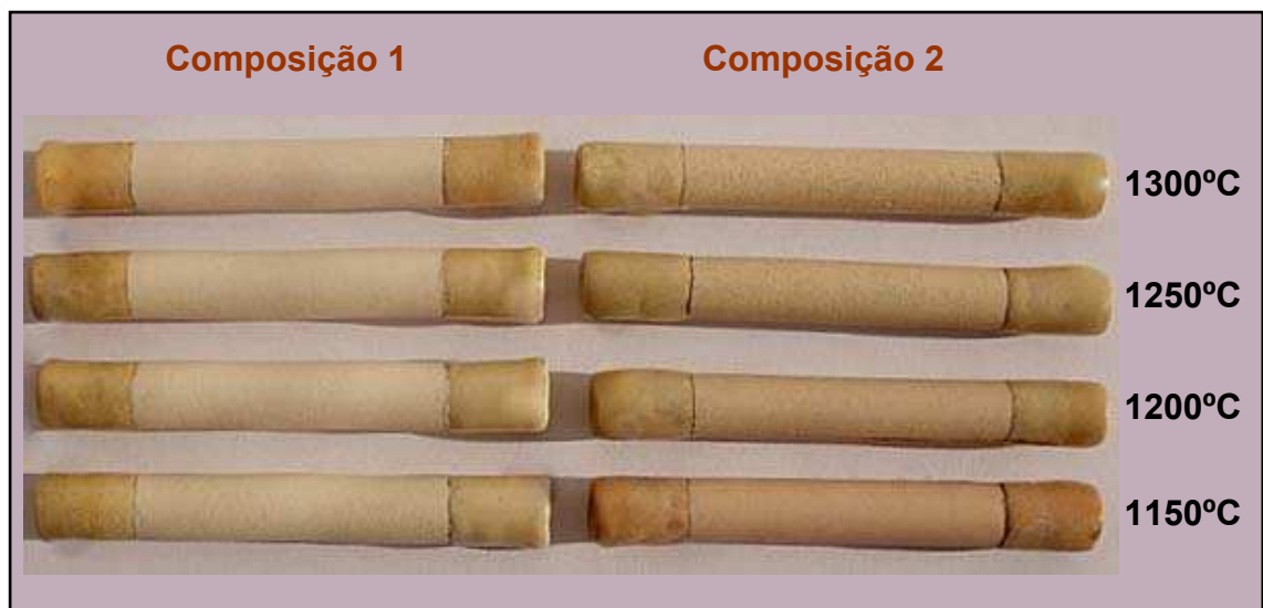
Figura 5.9. Imagem das membranas de cerâmica em função das composições e das temperaturas de sinterização.
