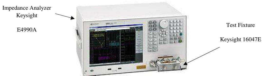
Figura 13 - Banco de testes para extração de impedâncias.
