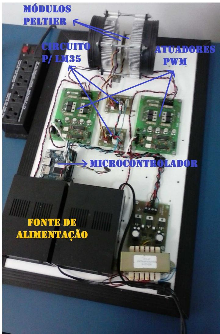
Figura 7 – Montagem presente no Laboratório de Controle e Otimização
