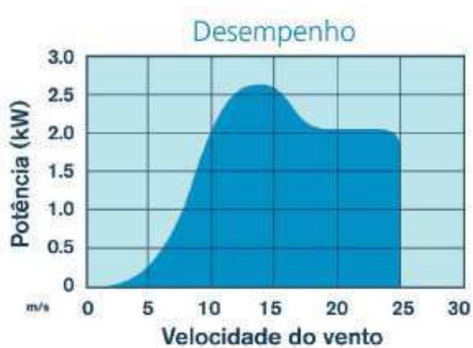
Figura 16. Desempenho do aerogerador *Skystream 3,7* em função da velocidade do vento.
