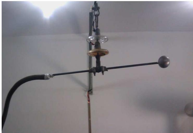
Foram usadas duas antenas para a captação dos dados, a primeira varria uma faixa de 30MHz a 330MHz, a segunda varria uma faixa mais ampla de 280MHz a 1080MHz. Pode-se ver nas Tabelas 2 e 3 a divisão das faixas de frequência dos dados adquiridos.
