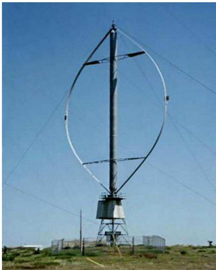
FIGURA 3 - TURBINA EÓLICA DE EIXO VERTICAL TIPO DARRIEUS
