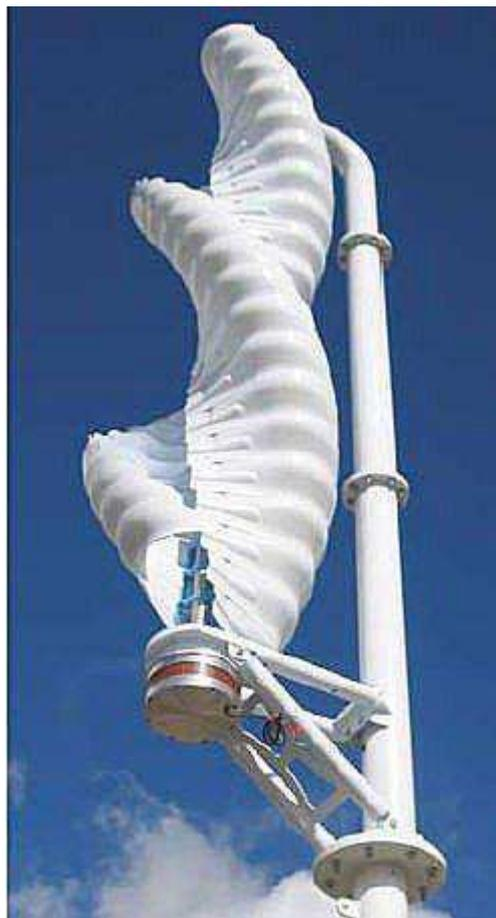
FIGURA 4 - TURBINA EÓLICA DE EIXO VERTICAL TIPO SAVONIUS
