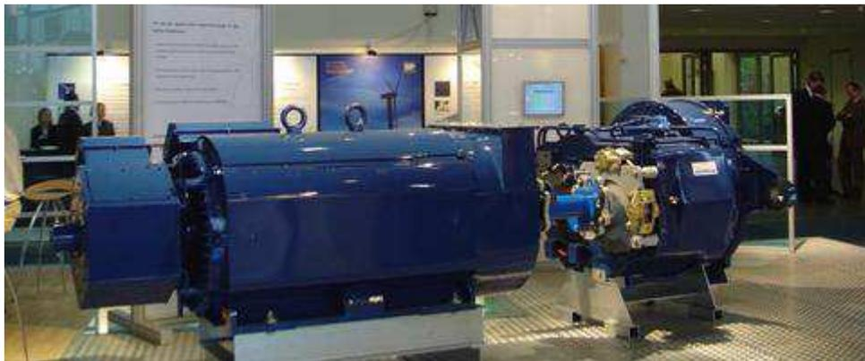
FIGURA 37 - GERADOR CONECTADO A UMA CAIXA MULTIPLICADORA DE VELOCIDADES
