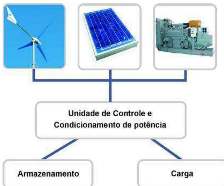
FIGURA 12 - CONFIGURAÇÃO DE UM SISTEMA HÍBRIDO
