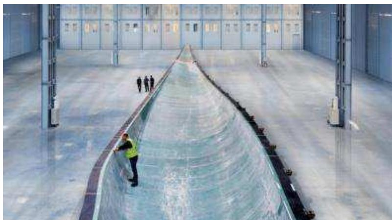
FIGURA 24 - PROCESSO DE FABRICAÇÃO DE UMA PÁ
