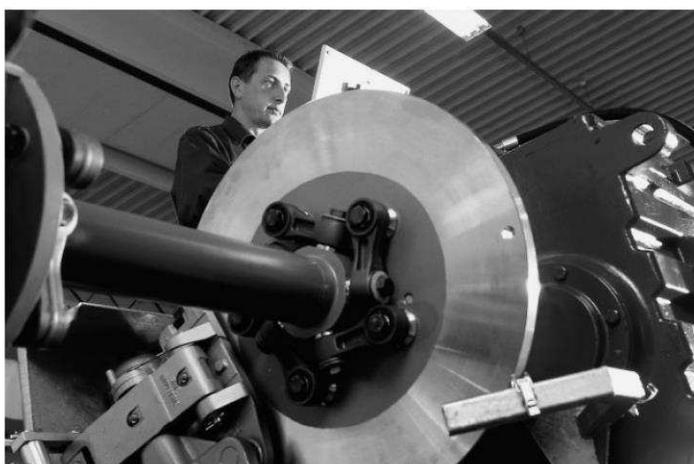
FIGURA 46 - DISCO DE FREIO E PINÇA PARA O EIXO DE ALTA VELOCIDADE
