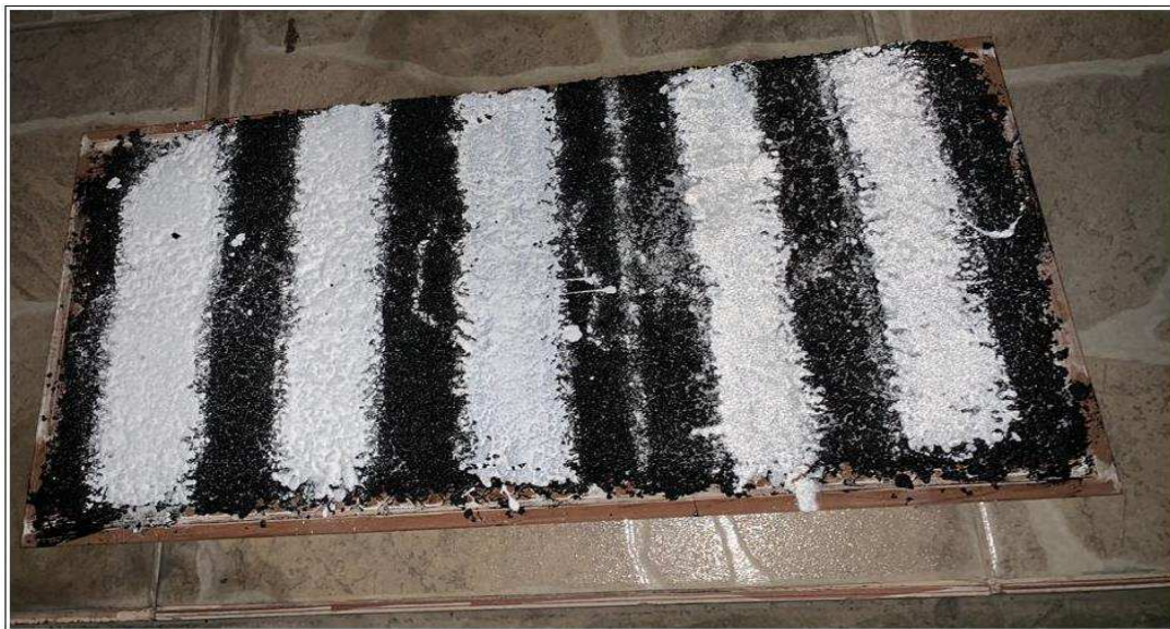
Figura 23: Aplicação de partículas de quartzo hialino e microesferas de vidro em superfície previamente preparada para receber as partículas.
