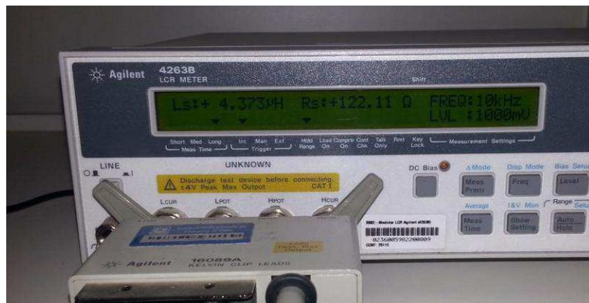
Figura 15. Medição da indutância do resistor de frente.
