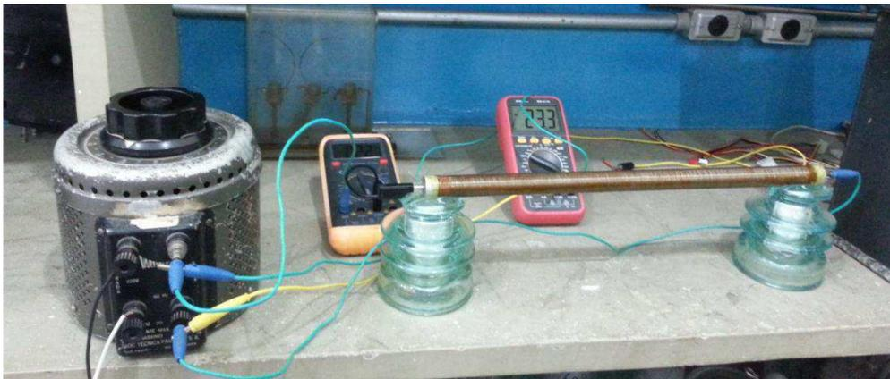
Figura 16. Verificação da operação do resistor de frente.
