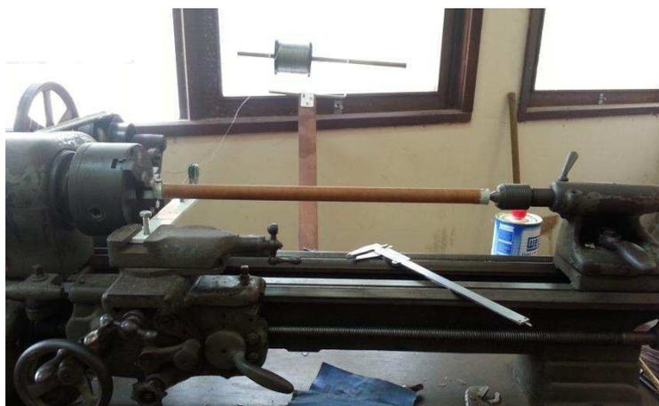
Figura 12. Arranjo para o enrolamento do resistor com o torno do DEE.
