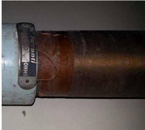
Figura 4. Resistor de fio do gerador de tensão impulsiva do LAT- UFCG.
