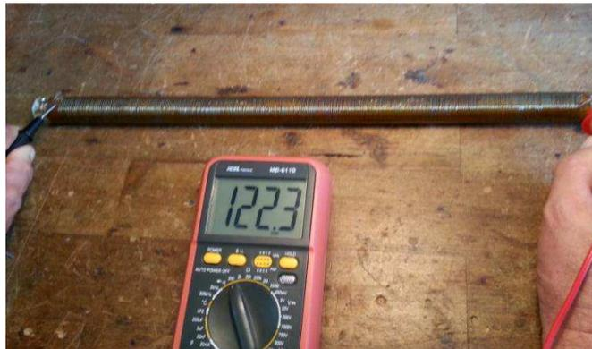
Figura 13. Medição do valor da resistência para o resistor de frente.
