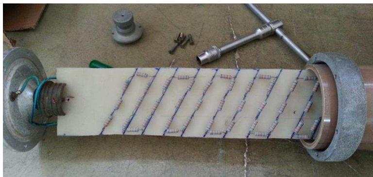
Figura 3. Resistor de 282 k $\Omega$  composto por resistores de camada de óxido metálico em série.
