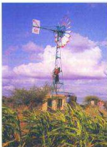
Figura 2 – Exemplo de um cata-vento de múltiplas pás instalado no Quênia.
