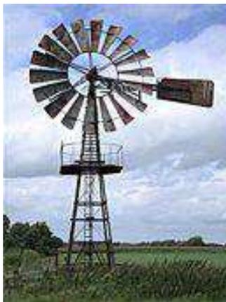
Figura 10 – Rotor de eixo horizontal com múltipás.<5>.
