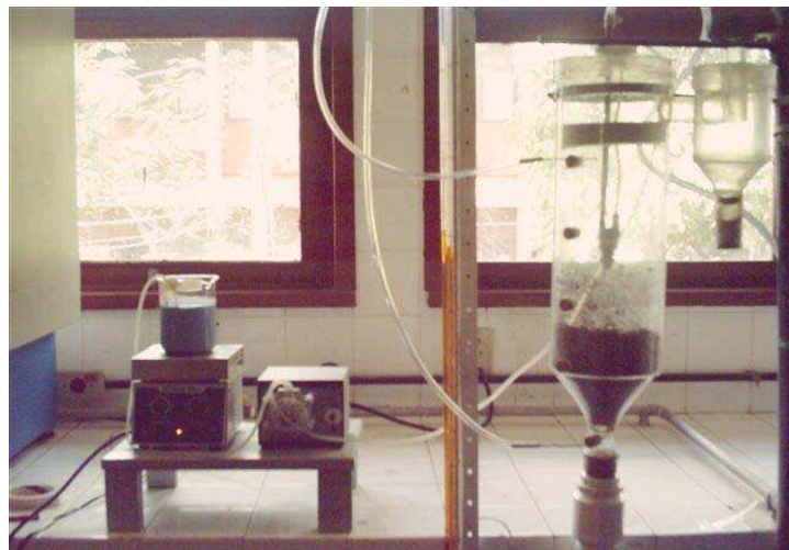
Figura 3.2 – Sistema experimental do secador de leito de jorro
