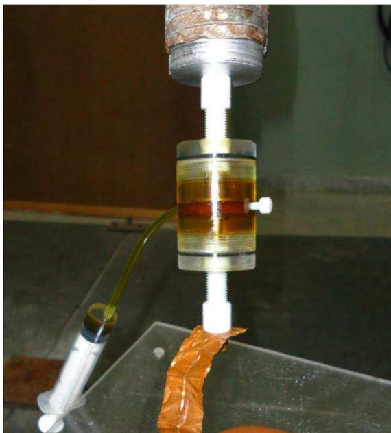
Figura 8 - Célula de teste preenchida com óleo de transformador, acoplado a uma seringa
