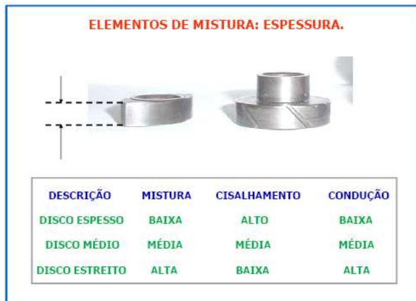
Figura 2.15: Influência da espessura dos lóbulos de elementos de malaxagem Fonte: FELISBERTI e SILVA, 2007
