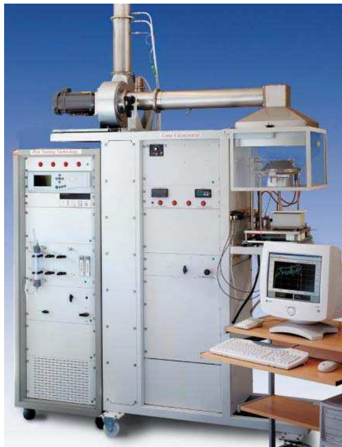
Figura 4.7: Modelo de um equipamento do Calorímetro de Cone Fonte: www.fire-testing.com , 2008
