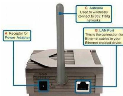
Figura 3 – Exemplo de um Wireless Bridge
