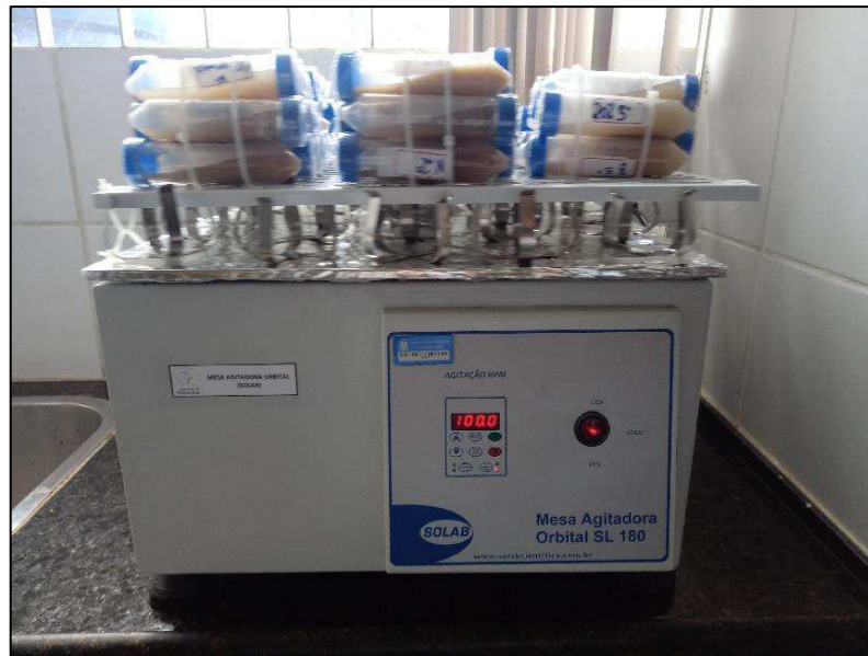
Figura 8 – Agitação dos tubos Falcon na mesa agitadora.
