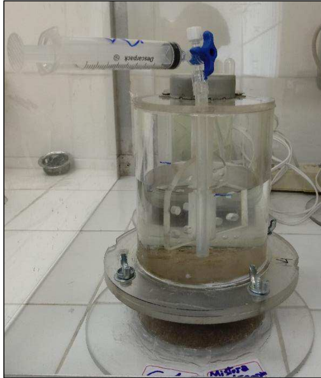
Figura 12 – Retirada de amostra da solução do reservatório da célula de difusão.
