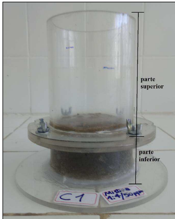
Figura 9 – Célula confeccionada para os ensaios de difusão.
