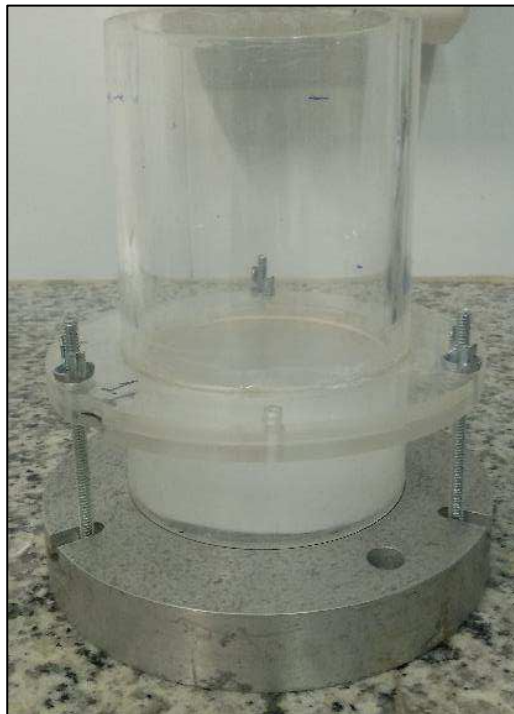
Figura 10 – Célula de difusão com base adaptada para a compactação do solo.
