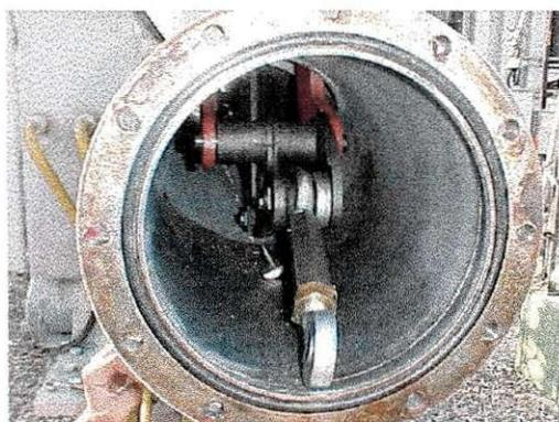
Figura 3.22. Mecanismo montado no interior do tubulão
