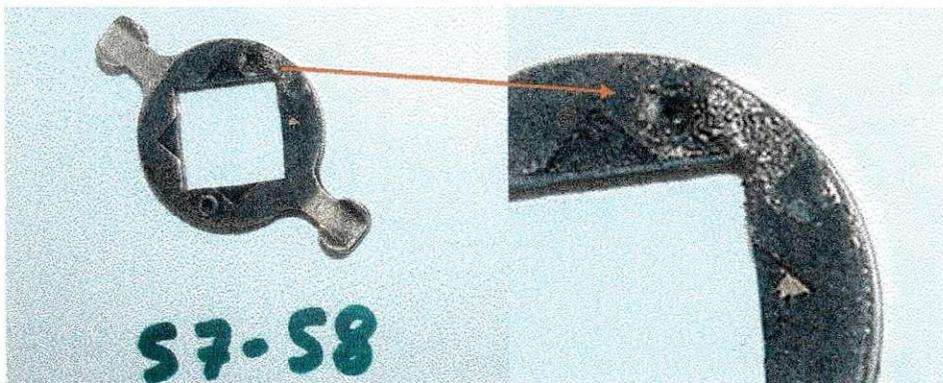
Figura 3.18. Carbonização do contato móvel.
