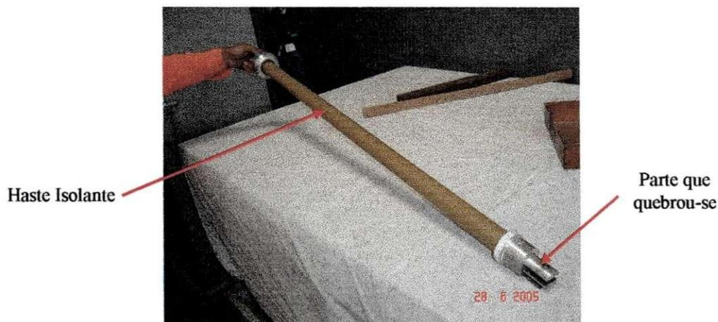
Figura 3.19. Haste semelhante à danificada
