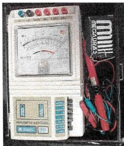
Figura 2.30. Medidor de resistência de isolamento
