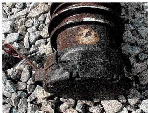
Figura 3.24. Haste de Manobra Avariada. Figura 3.25. Terminal do capacitor de equalização danificado
