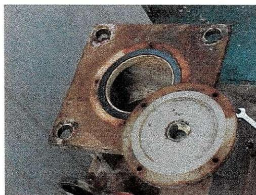
Figura 3.27. Ferrugem na caixa de mecanismo
