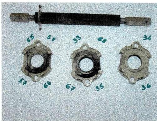
Figura 3.17. Sinais de carbonização nos suportes isolantes dos contatos da chave.
