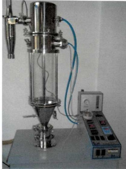
**Figura 3.11.** Secador de leito de jorro utilizado no experimento
