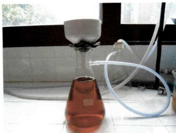
**Figura 4.13.** Filtração a vácuo da solução extrativa
