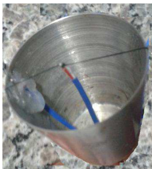
Figura 3.11 – Posicionamento dos termopares no recipiente.
