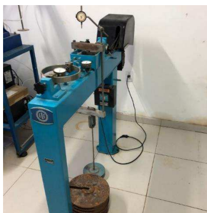
Figura 25: Prensa de cisalhamento direto utilizada na pesquisa.
