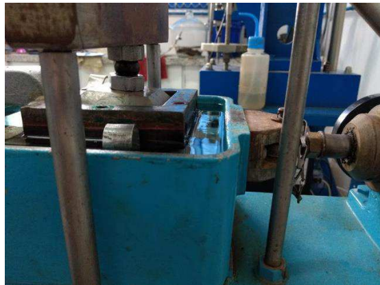
Figura 27: Caixa bipartida imersa em ácido acético.
