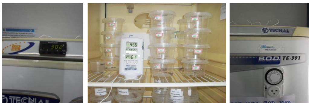
Figura 8 – Instalação do bioensaio para avaliação de parâmetros demográficos tabela de vida e fertilidade de Zabrotes subfasciatus em câmara climatizada B.O.D.
