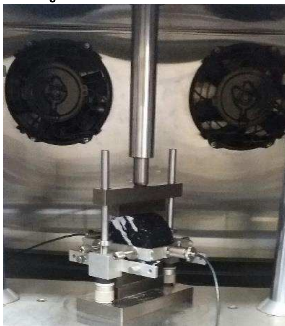
Figura 16: Ensaio módulo de resiliência
