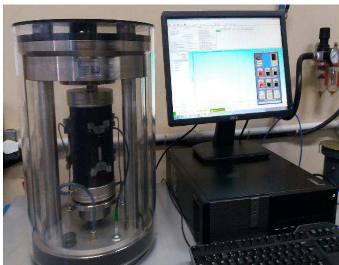
Figura 17: Ensaio de Módulo Dinâmico
