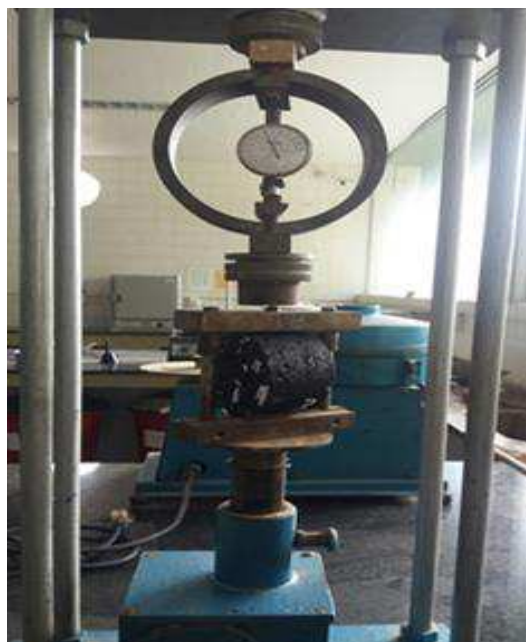
Figura 15: Ensaio de resistência a tração por compressão diametral
