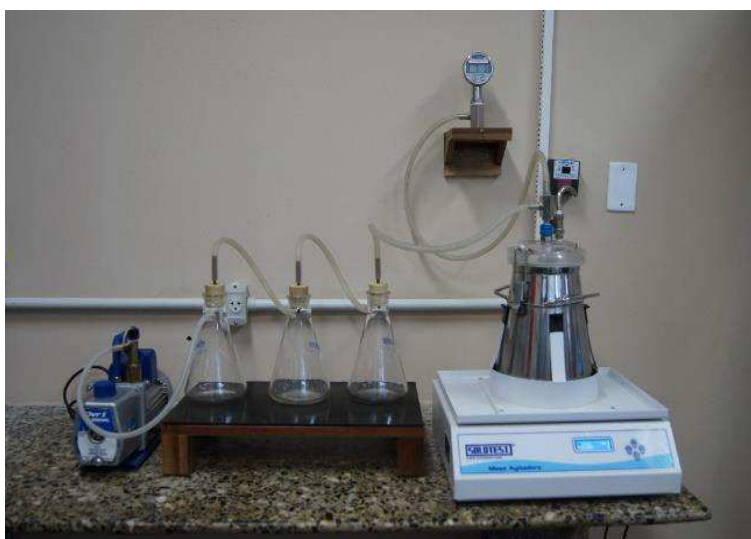
Figura 14: Equipamento para ensaio de determinação do Gmm - Rice Test
