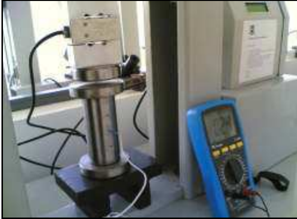
FIGURA 3.12 - Ensaio preparado para execução no equipamento de medição de pressão de expansão desenvolvido nesta pesquisa.
