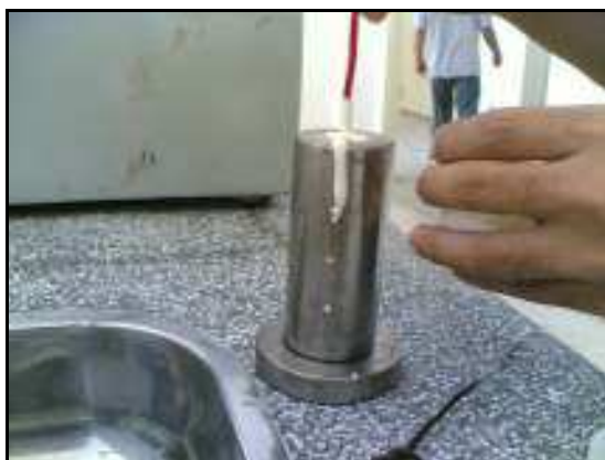
FIGURA 3.11 - Corpo de prova (molde) sendo preenchido com argamassa expansiva
