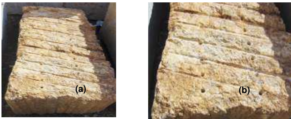
FIGURA 3.15 – Fotografia do bloco de granito usado na aplicação da argamassa teste e chinesa, após a ruptura das aplicações de argamassa italiana e empíricas. (a) vista geral do bloco. (b) detalhe das duas linhas restantes de furação do bloco de granito.
