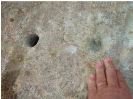
FIGURA 4.27 - Bloco sem ruptura após aplicação da argamassa A1.
