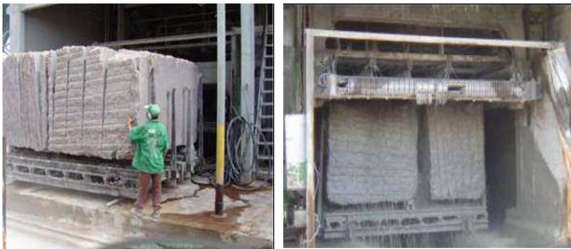
FIGURA 2.3 – Tear de Lâminas usado no desdobramento de blocos de granitos em chapas na empresa FUJI S/A – Campina Grande/PB
