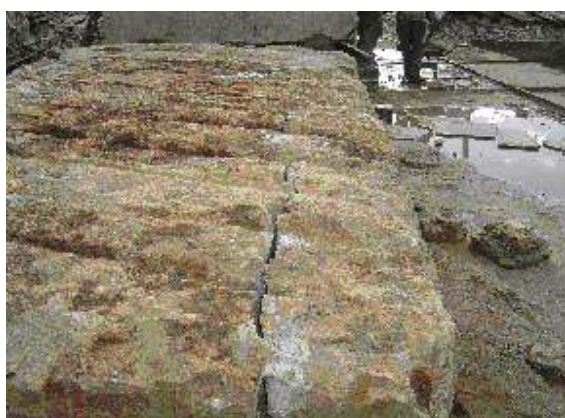
FIGURA 4.29 - Início da ruptura (propagação da trinca) pela expansão da argamassa comercial italiana.
