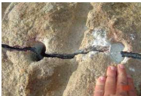
FIGURA 4.28 - Bloco rompido pela argamassa comercial italiana.
