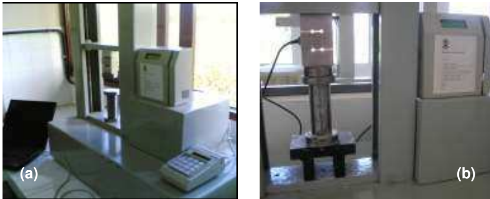
FIGURA 3.10 – Equipamento de medição de pressão de expansão em pleno funcionamento, após o re-projeto e calibração final da máquina: (a) painel de controle. (b) célula de carga e molde do corpo de prova.
