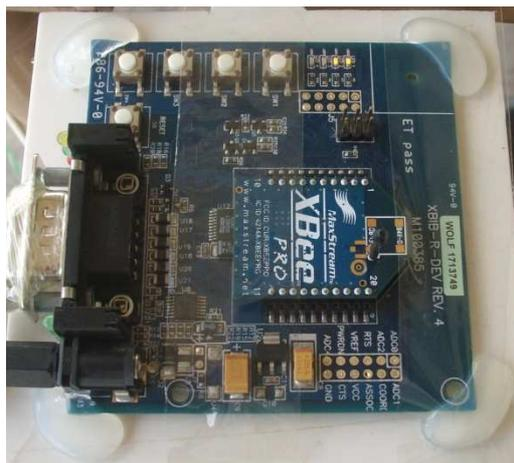
**Figura 12 – Nó formado pelo ADuC e o XBee-Pro**
