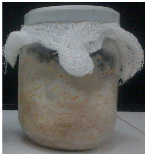
Figura 8: Sistema de cultivo de P. castanella (Substrato, óleo, tween, RBBR e pedaços de PP).
