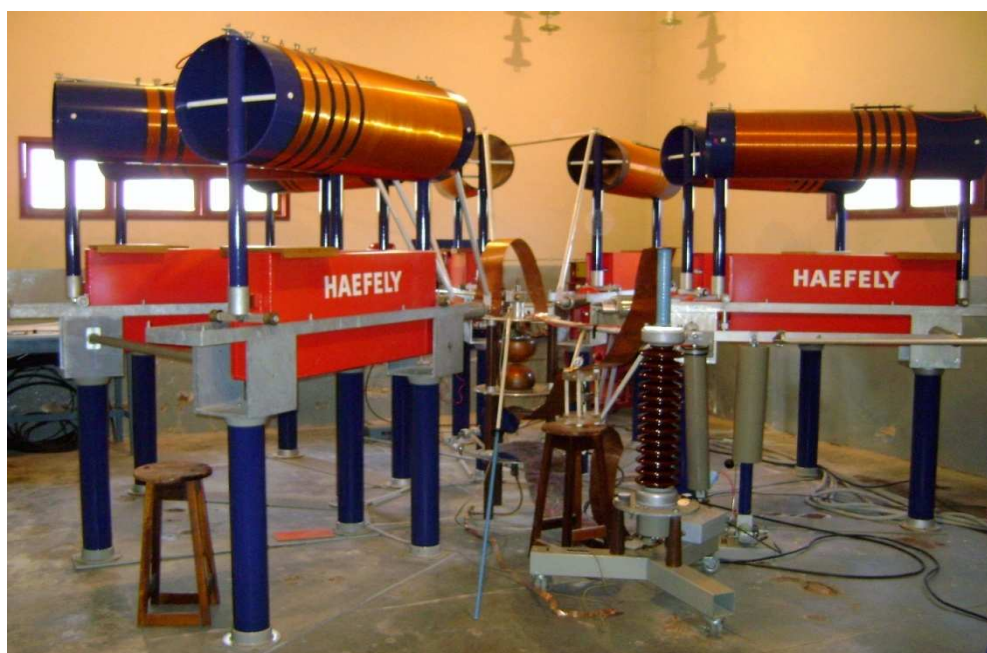
Figura 4.2 - Gerador de impulso de alta corrente Haefely.
