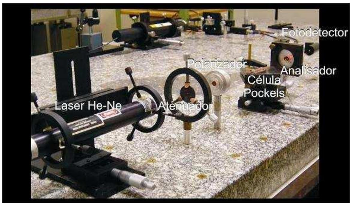
Fig.4-2. Sensor óptico de tensão montado num laboratório. <sup>[3]</sup>
