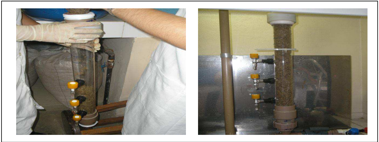
FIGURA 12 - Etapas para o empacotamento do bagaço de cana.
