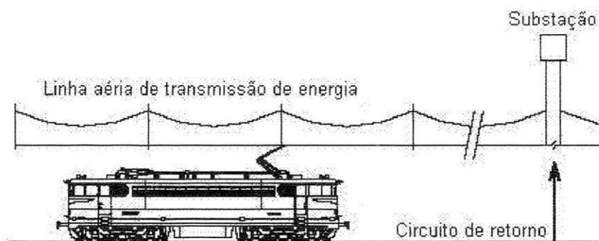
Figura 3.1 – Sistema de tração elétrica.
