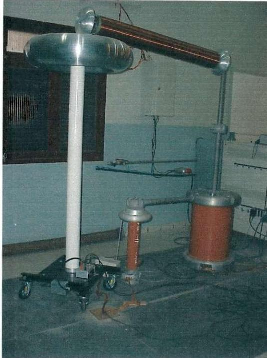
**Figura 22 - Arranjo do sistema de medição de descargas parciais com capacitor de acoplamento e bobina de bloqueio (NERI, 2008).**
