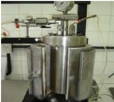
Figura 3.2. Reator utilizado nos experimentos para as hidrólises ácidas
