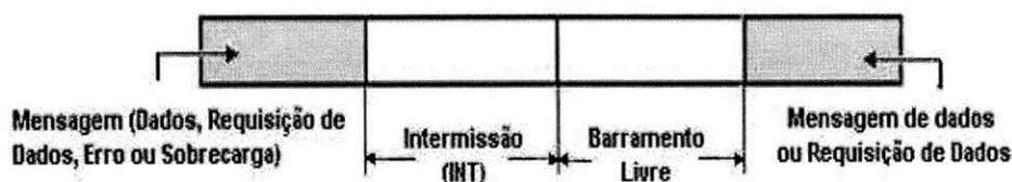
Figura 2.18: Diagrama do Intervalo *Interframe* para Nós não Passivos.
