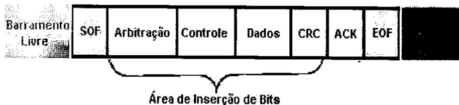
Figura 2.21: Diagrama com os Campos de uma Mensagem que estão Submetidos ao Método da Inserção de *Bits*.
