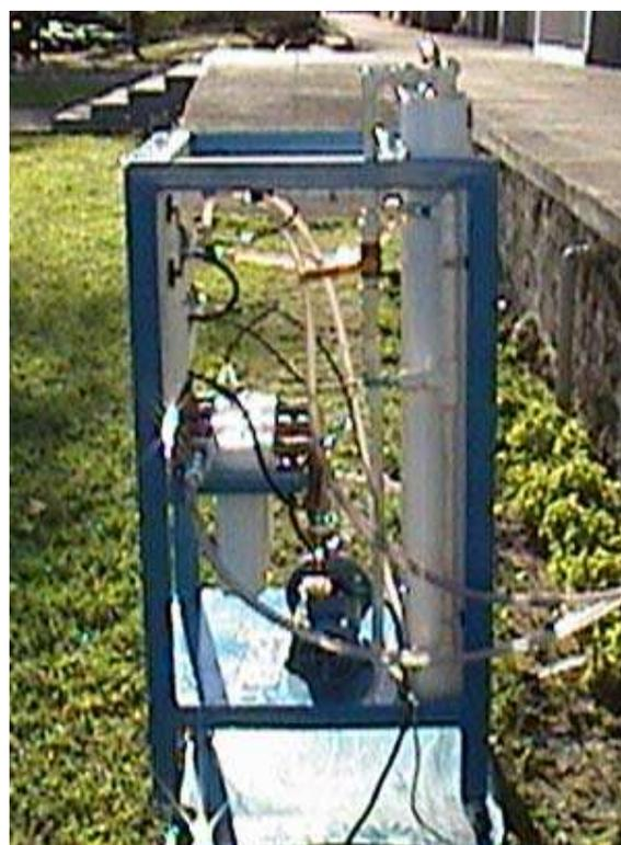
Figura 3.4: Vista lateral do sistema de dessalinização
