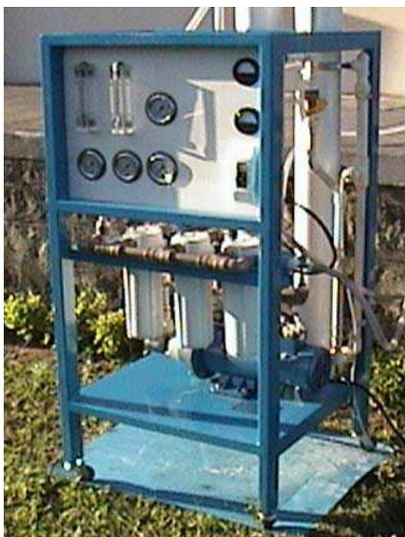
Figura 3.3: Vista frontal do sistema de dessalinização
