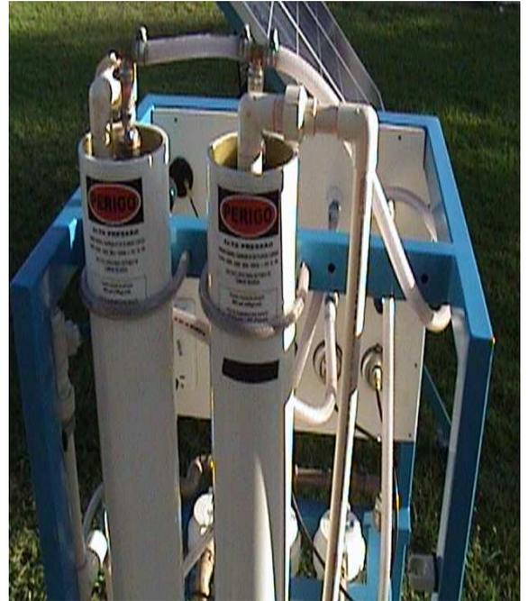
Figura 3.6: Vista das membranas de osmose inversa
