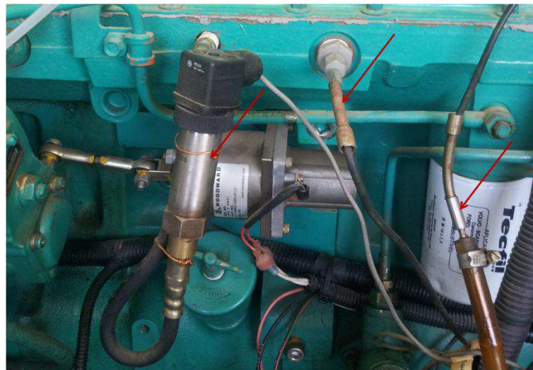
Figura 3.7 - Transdutor de pressão no coletor de admissão, termopares no coletor de admissão e na linha de óleo combustível.
